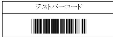
カーソルの位置に「12345」と入力されていればテスト OK です。セットアップは完了しました。この後、必要に応じて、各種パラメータを設定してください。
