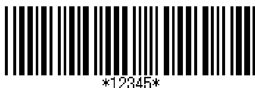
CODE39(データ5桁)の例
