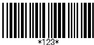
CODE39(データ3桁)の例
